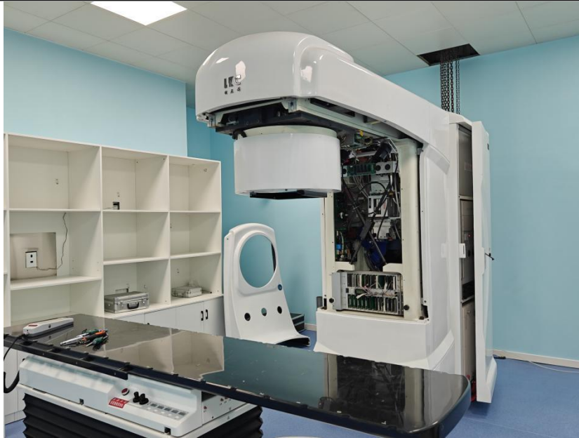
图 2-3：本项目医用直线加速器照片（调试中）
